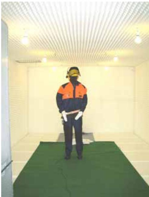
**Abbildung 61: Versuchsaufbau im reflexionsarmen Raum**
