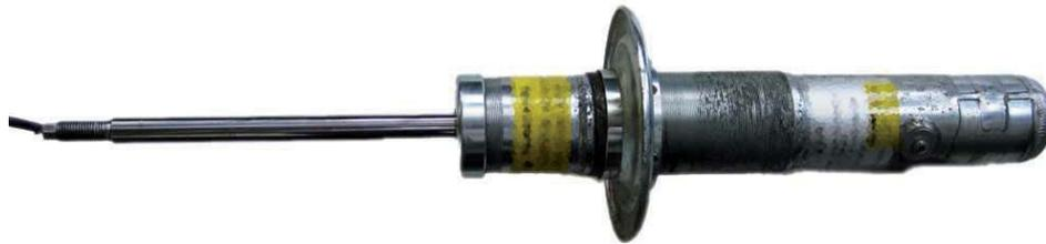
Abbildung 3.3: Der Zweirohrdämpfer der Hinterachse.
