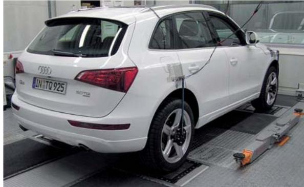
Abbildung 3.2: Das Versuchsfahrzeug auf dem Hydropulsprüfstand.
