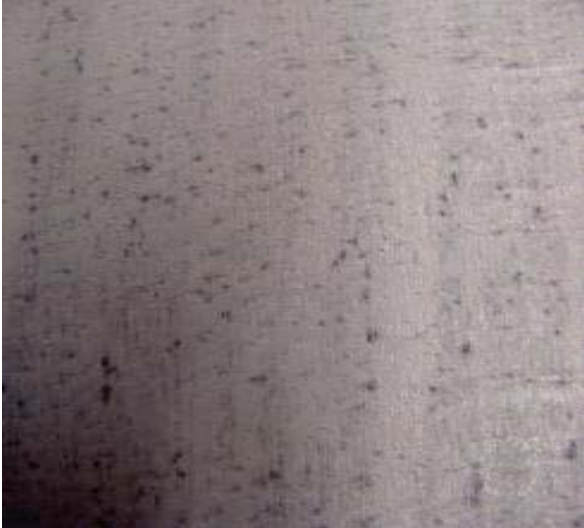
Abb. 7: Dunkle Stippen nach dem ersten Anstrich, lösemittelverdünnbare Alkyd Holzfarbe
