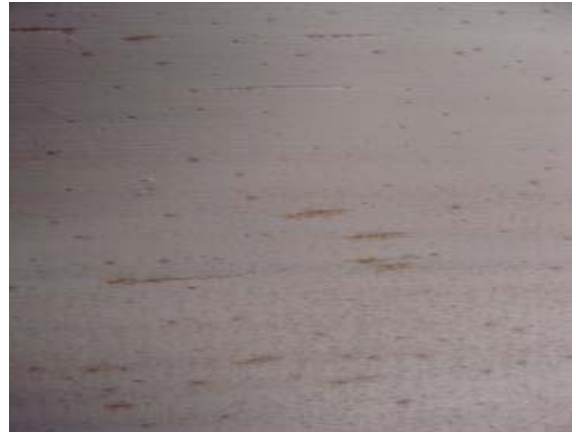
Abb. 9: Braune feine längliche Stippen, lösemittelverdünnbare Alkyd Holzfarbe
