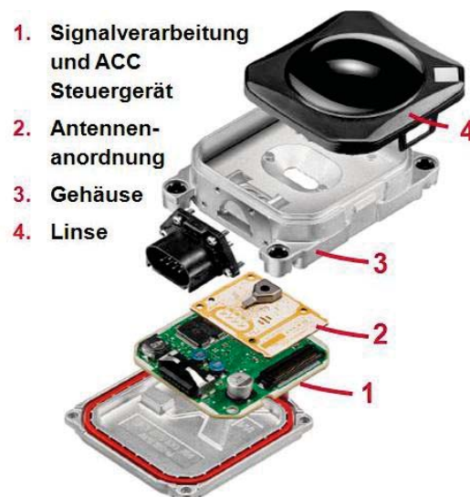
Abbildung 3.3: Explosionsdarstellung des LRR3 aus Lucas (2009)
