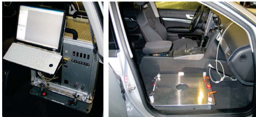
Abbildung 5.11: Montage der RefBox im Fahrzeug anstelle des Beifahrersitzes aus Strasser u. a. (2010)
