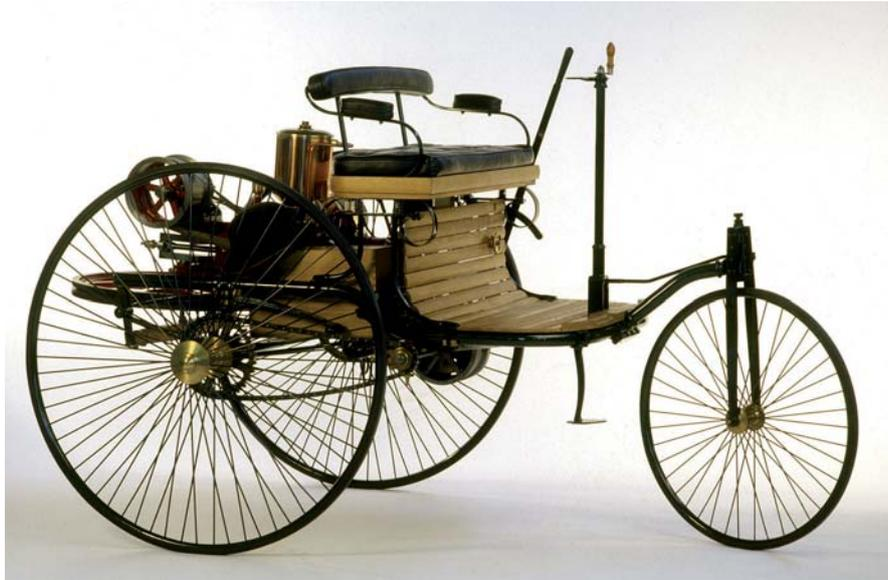
**Abbildung 1.1:** Benz Patent-Motorwagen 1 von 1886
