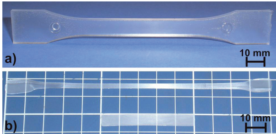
Abbildung 4-5: Probengeometrien der spritzgegossenen FGP-Proben: (a) Zugstab, (b) Biegestab im Ausgangszustand und gedehnt.
