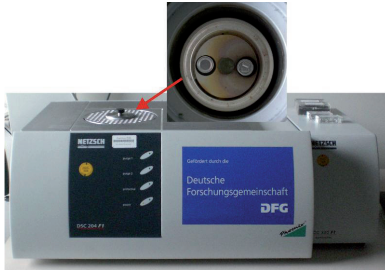
Abbildung 4-9: Dynamisches Differenz-Kalorimeter der Firma Netzsch mit einer vergrößerten Darstellung des Probenraumes.
