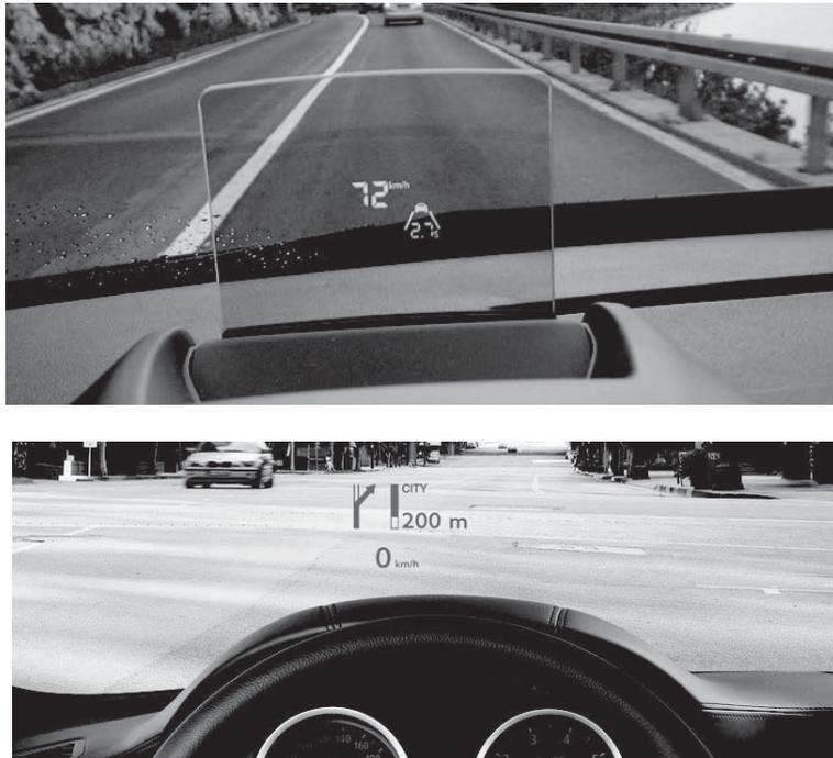
*Abbildung 4.9: Unterschiedliche Positionierung des virtuellen Bildes: Das obere Head-up Display weist einen inhomogenen Hintergrund (Fahrbahn und Motorhaube) auf, was zu erschwertem Able- sen führen kann, das untere zeigt nur die Fahrbahn als Hintergrund.*
