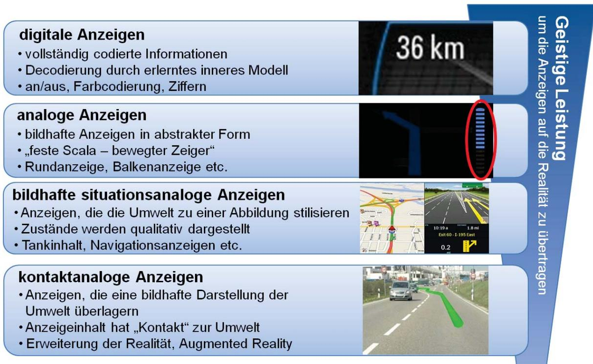
Abbildung 3.6: Darstellungsformen visueller Anzeigen und die benötigte geistige Leistung, diese auf die Realität zu übertragen, am Beispiel von Navigationsanzeigen
