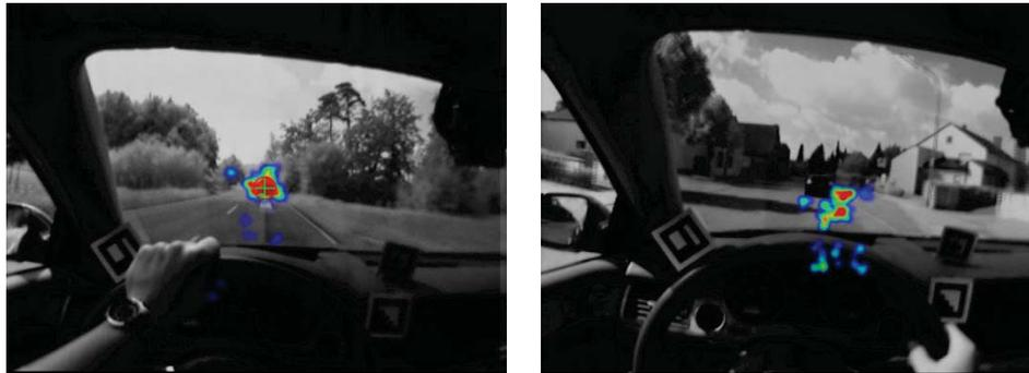
*Abbildung 7.11: Häufigkeitsverteilung der Blicke 15 sec vor der Übernahmeaufforderung. Rot entspricht den häufigsten Bereichen. Kontaktanaloge Anzeige ACC-high links, Anzeige im Kombiinstrument rechts.*
