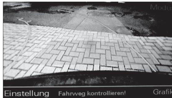
Abbildung 3.7: Bild einer Rückfahrkamera mit Fahrzeuglänge (blau) und eingeschlagener Trajektorie (rot)
