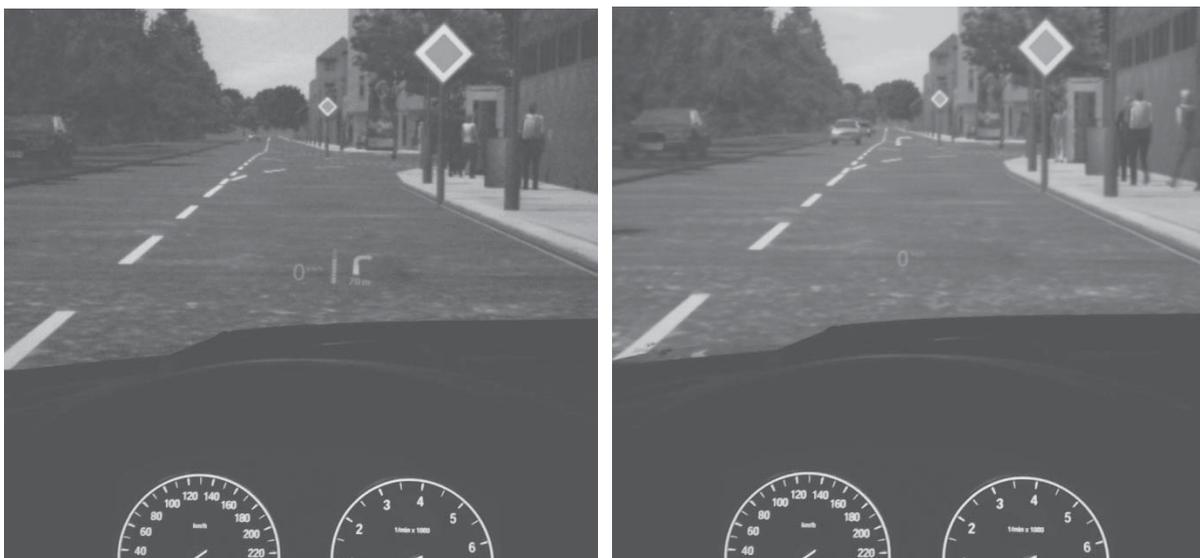
Abbildung 7.24: HUD-Anzeige (links) und kontaktanaloge Anzeige (rechts) aus Fahrersicht
