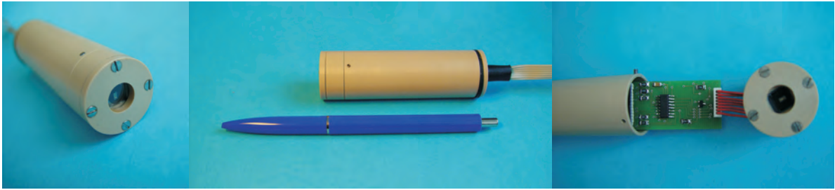
Abbildung 4.14: Der Sensor aus verschiedenen Perspektiven. Das Gehäuse beinhaltet die Elektronik, sowie das MORES ® -Modul. Es besteht aus PEEK und ist damit widerstandsfähig gegen die basische Umgebung. Die Dichtungen sind aus EPDM und schützen das Innere vor Feuchtigkeit.
