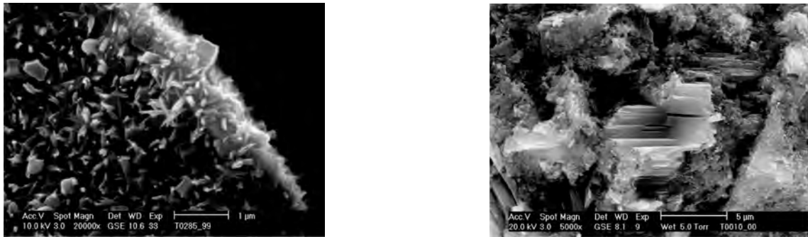
Abbildung 2.2: Links: ESEM-Aufnahme von Zementstein nach drei Stunden Hydratation. Sichtbar sind erste nadelige CSH -Primärkristallite und kurzstengelige prismatische Ettringitkristalle. Rechts: ESEM-Aufnahme von Zementstein nach 28 Tagen Hydratation. Sichtbar sind das dichte CSH -Gefüge und bankige Calciumhydroxidkristalle [2].
