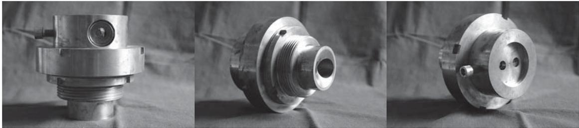
**Abbildung 6.1:** Fotos der genutzten Sonde. Der Messkanal ist im rechten Bild rechts, das linke Bild zeigt den Blick durch die Messfenster.
