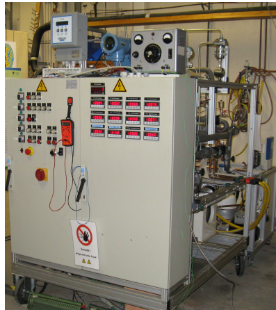
Abbildung 4.1: Foto des Ejektor-Prüfstands, der am IfT aufgebaut wurde
