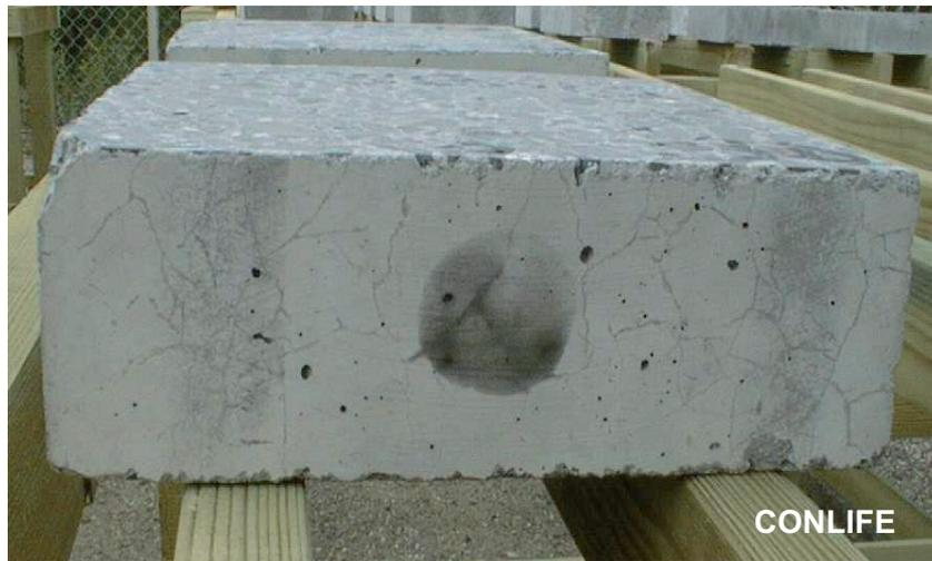
**Abbildung 4.2:** Rissbildung auf der exponierten Betonoberfläche nach einem Winter Auslagerung (56 Frost-Tau-Wechsel und Minimaltemperaturen bis  $-40^{\circ}\text{C}$ );  $w/b = 0,42 + 7\%$  Microsilica; entnommen aus [Hol04b].
