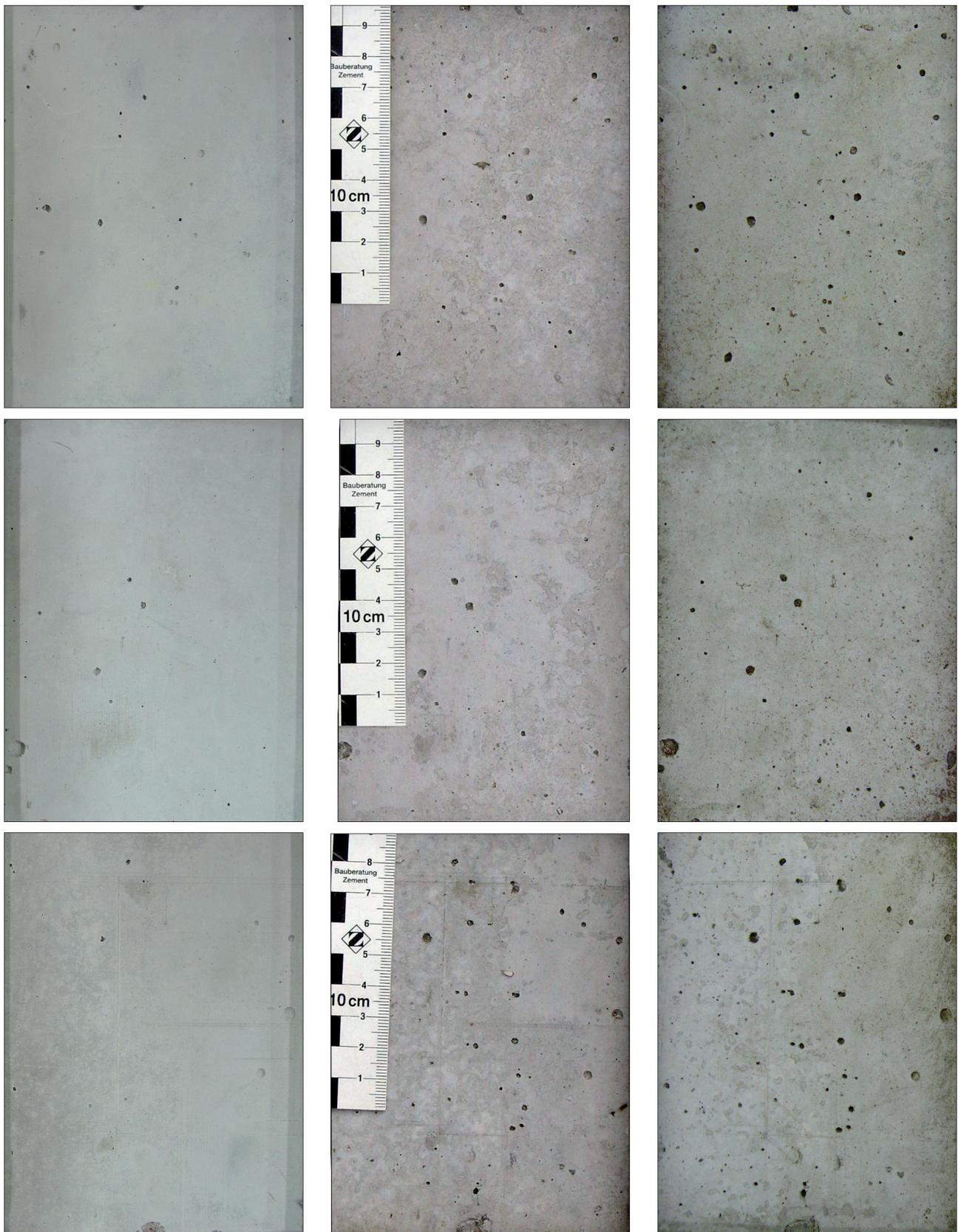
**Abbildung A.5:** Betonserie H: äußere Schädigung ausgelagerter Proben – links: vor Auslagerung; Mitte: nach Frostperiode 06/07; rechts: nach Frostperiode 07/08.
