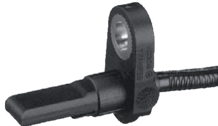
Abbildung 2-9: Aktiver ESP-Drehzahlsensor [Rei10, S. 99]
