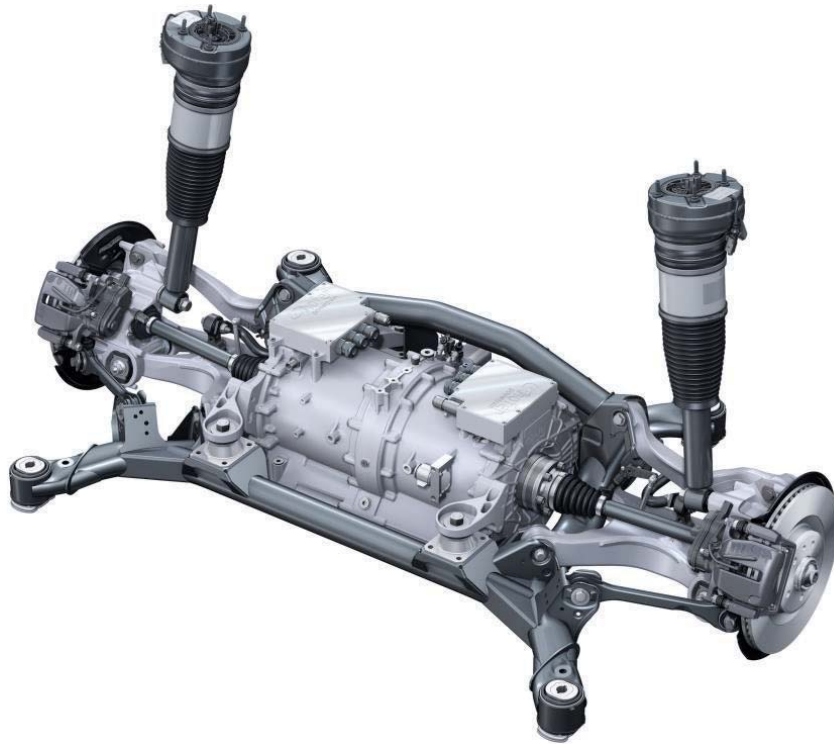
Abbildung 2-6: Modifizierter Hilfsrahmen mit elektrischem Antrieb
