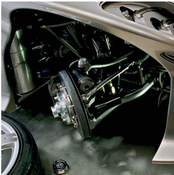
Bild 2.13: „Active Tire Tilt Control“ System des Konzeptfahrzeugs F400 Carving [36].
