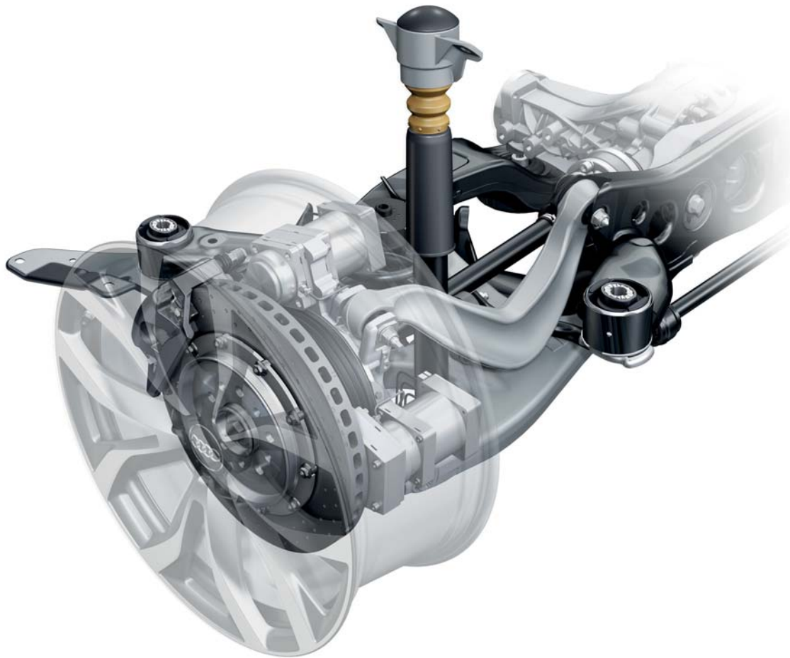
Bild 6.1: Package-Integration des aktiven Radträgers an der Hinterachse eines Audi A4 mit Allradantrieb. An dem serienmäßigen Fahrwerk wird dabei der passive durch den aktiven Radträger substituiert [4].
