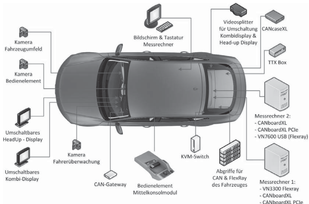
Abbildung 4.1: Versuchsträger A7 mit Erweiterungen nach [2]
