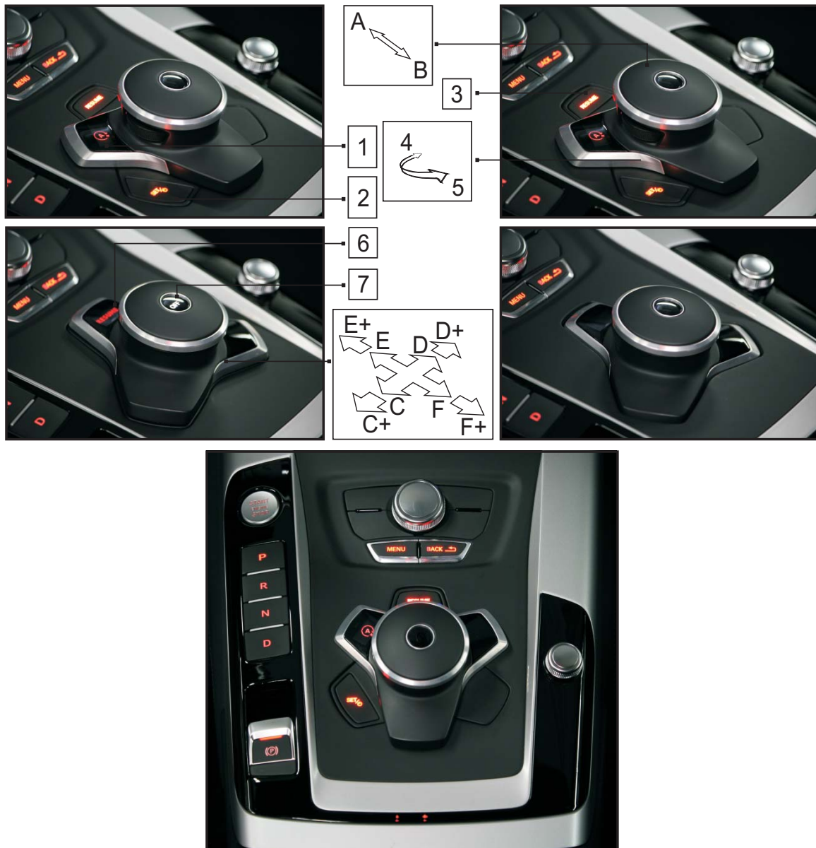
Abbildung 4.9: Prototypische Umsetzung und Betätigungsmöglichkeiten des integrativen Stellelements HBA für die Modi MF (oben links), TA (oben rechts), VA (mitte links) und AUTON (mitte rechts)
