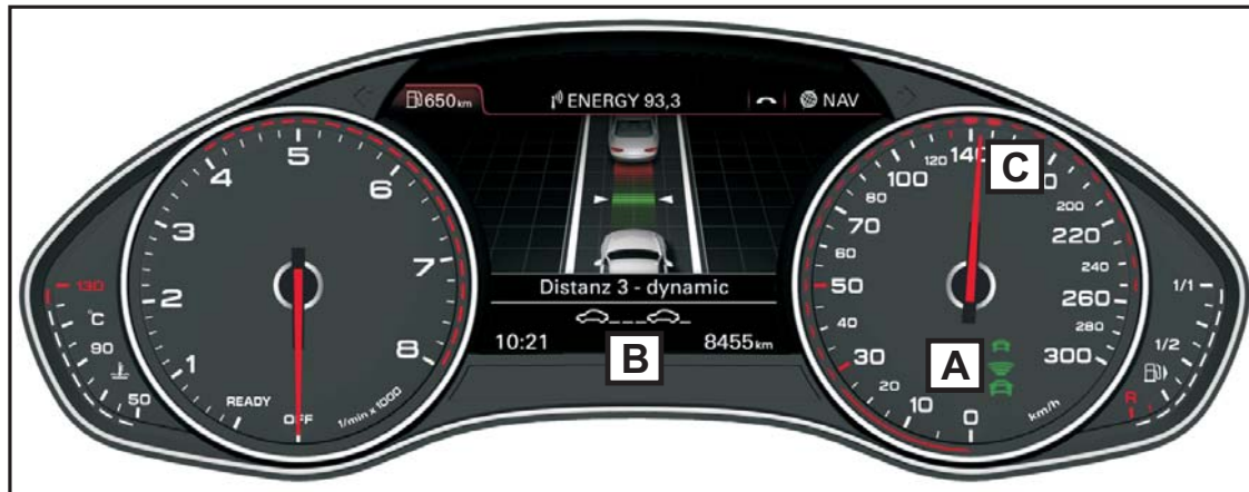
Abbildung 2.8: ACC-Anzeigekonzept eines AUDI A6 nach [4]
