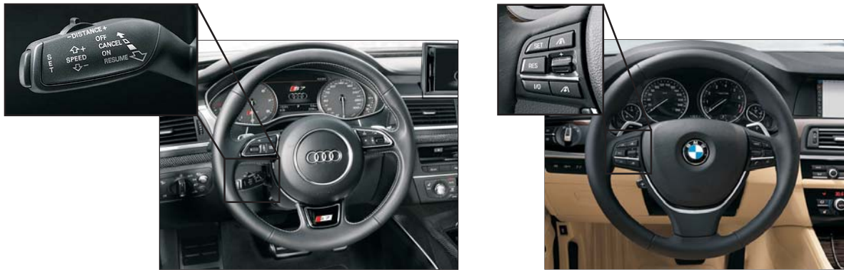
Abbildung 2.7: ACC-Bedienelemente der BMW AG und der AUDI AG, adaptiert nach [10], [5] und [130]
