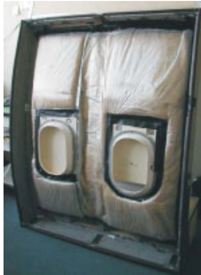
Abbildung 3.3: Seitenlining mit Sekundärisolierung an einem Versuchsstand
