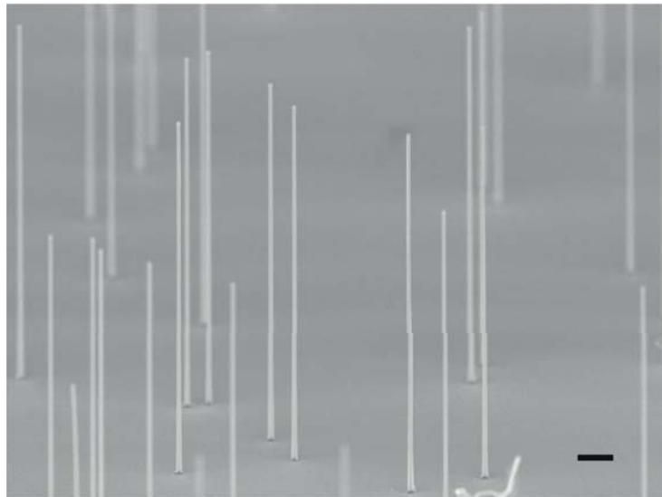
**Abb. 3.6:** REM-Aufnahme von p-dotierten GaAs-Nanodrähten, die mit 2 min Zink-Vorsättigung aus den kolloidalen Au-Nanopartikeln mit einem Durchmesser von 100 nm gewachsen wurden. Der Messbalken beträgt 1  $\mu\text{m}$ .
