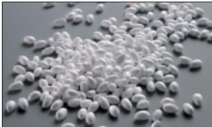
Abb. 3.21: Infinergy®-Partikel, hergestellt von der *BASF AG*, mit einer Größe von  $d = 5 - 10$  mm. Die Partikel lassen sich beispielsweise durch Verkleben zum Endprodukt weiterverarbeiten. Abbildung entnommen aus [165].
