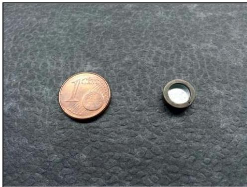
Abb. 3.8: Im Rahmen der Experimente verwendetes Aufschäumtöpfchen (rechts), in welches das Ausgangsgemisch eingebracht wird. Durch die Halterung wird ein Verstopfen der Kapillaren der Hochdruckzelle vermieden und das Entnehmen der expandierten Probe erleichtert. Hergestellt von der hauseigenen, feinmechanischen Werkstatt. Zum Größen-Vergleich ist eine 1-cent-Münze (links) dargestellt.
