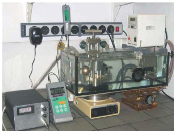
Abb. 2.30: Aufbau der Messapparatur mit befüllter Hochdruckzelle. Die Temperatur des Wasserbeckens wird mittels des eingehängten Thermostaten eingestellt. Der Druck innerhalb der Messzelle kann anhand eines angeschlossenen Druckanzeigers abgelesen werden. Zu sehen sind außerdem Temperaturanzeiger, Magnetrührer und Polarisatoren [131].
