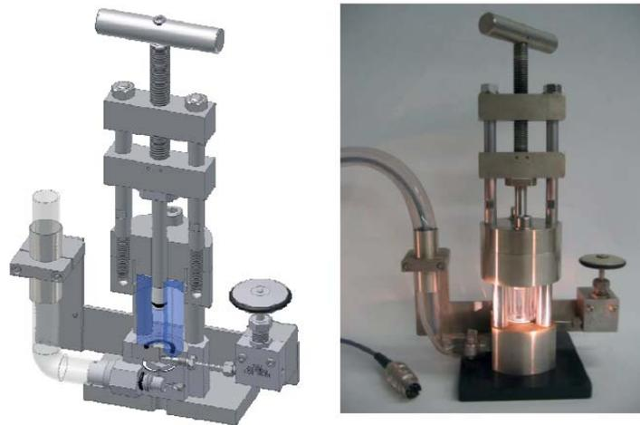
Abb. 2.29: Technische Zeichnung der eigens für Hochdruckmessungen von SCHWAN konzipierten Hochdruckzelle (links). Über den Stempel lässt sich der Druck variieren. Der transparente Saphirzylinder, in welchen die Probe eingefüllt wird und der den Kern der Messzelle darstellt, ist blau eingefärbt. Rechts: Foto der Messzelle. Entnommen aus [131].
