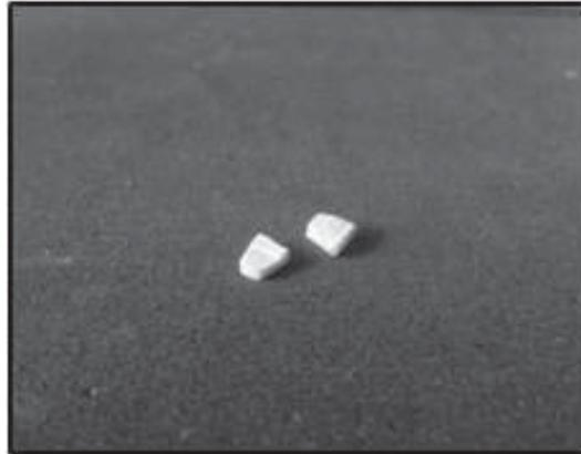
Abb. 3.24: Aufnahme eines flexiblen Schaums, erhalten aus der Umsetzung von thermoplastischen PU-Partikeln mithilfe des NF-CID-Verfahrens.
