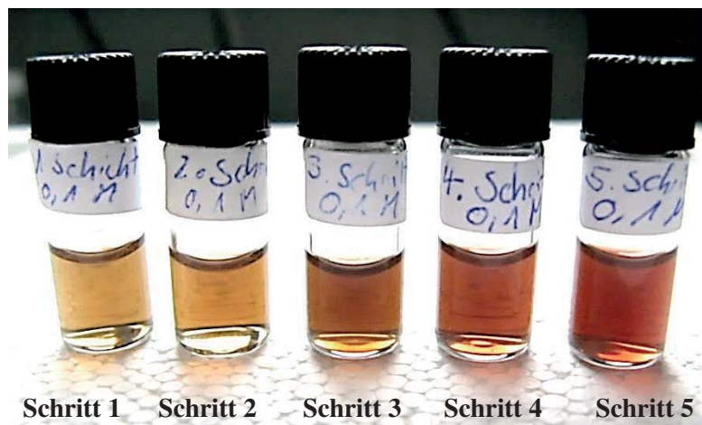
Abb. 12: Schrittweise Ummantelung der magnetischen Kerne mit einer Goldschale. [75]
