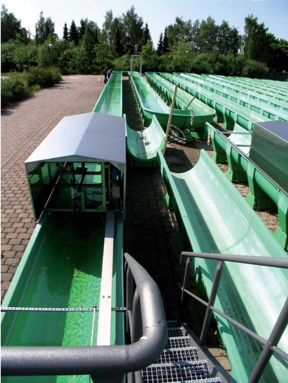
**Abbildung 5:** Kombi-Rinne 1-2. Links unter dem Blechdach die Online-Messtechnik (eigenes Foto)
