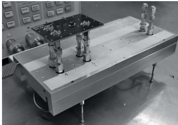
Abbildung 3.2 – Messplatz zur Ermittlung der Modenkonzersion von Gleichtaktdrosseln
