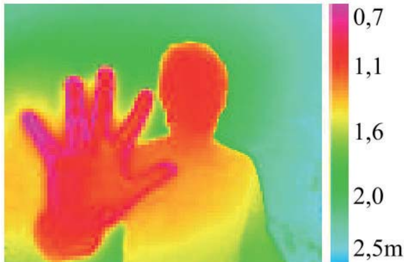
Abbildung 2.13: Distanzbild einer von Scattering beeinflussten Aufnahme [41]. Insbesondere in dem Bereich, der sich links neben der Hand befindet, werden zu geringe Distanzen gemessen.
