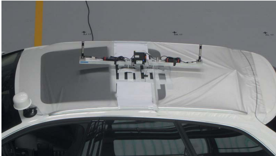
Abbildung 7.6: Befestigung der iGPS -Empfänger auf dem Dach des Fahrzeugs durch einen starren Körper
