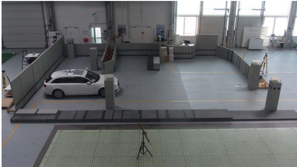
Abbildung 7.1: Die Messhalle, die mit einem Referenzsystem zur Bestimmung der Fahrzeugposition ausgestattet ist.
