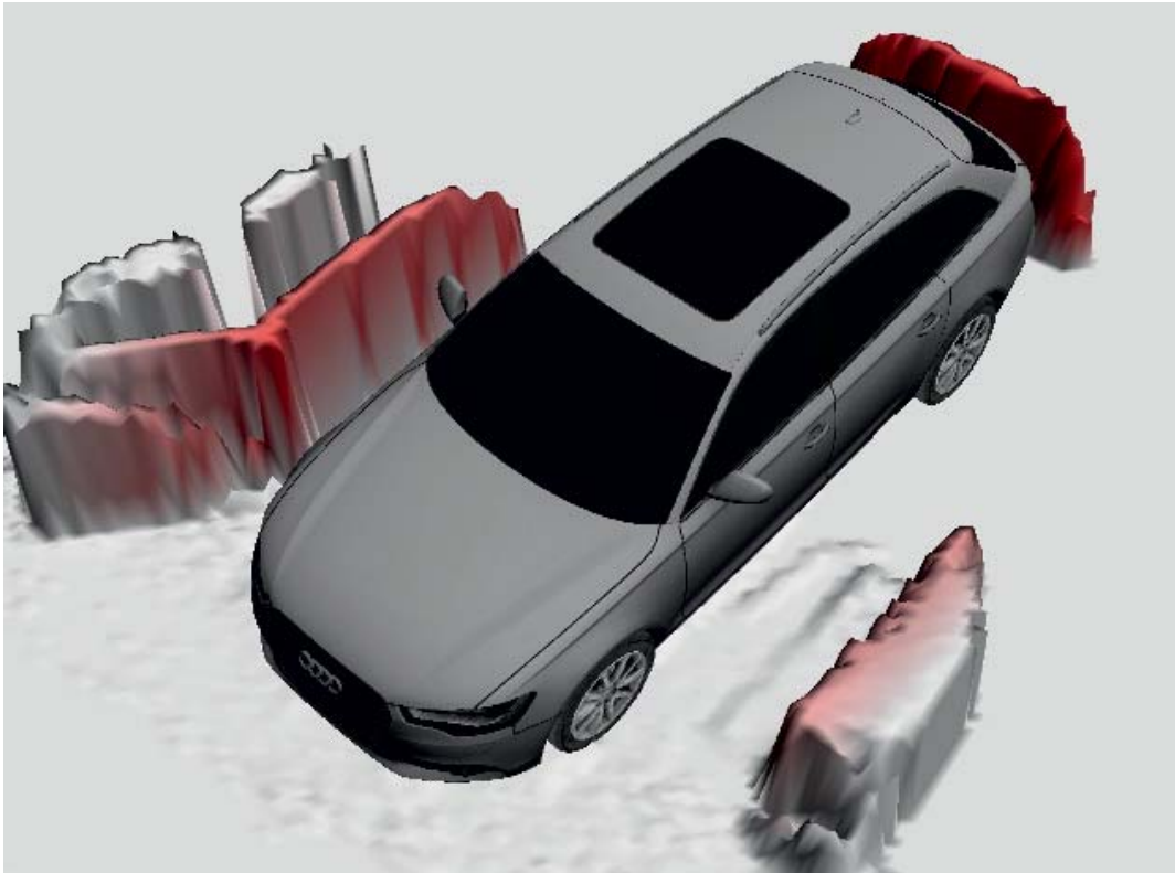
Abbildung 5.7: Einfärbung der nahen Hindernisse abhängig von der Distanz zum Fahrzeug
