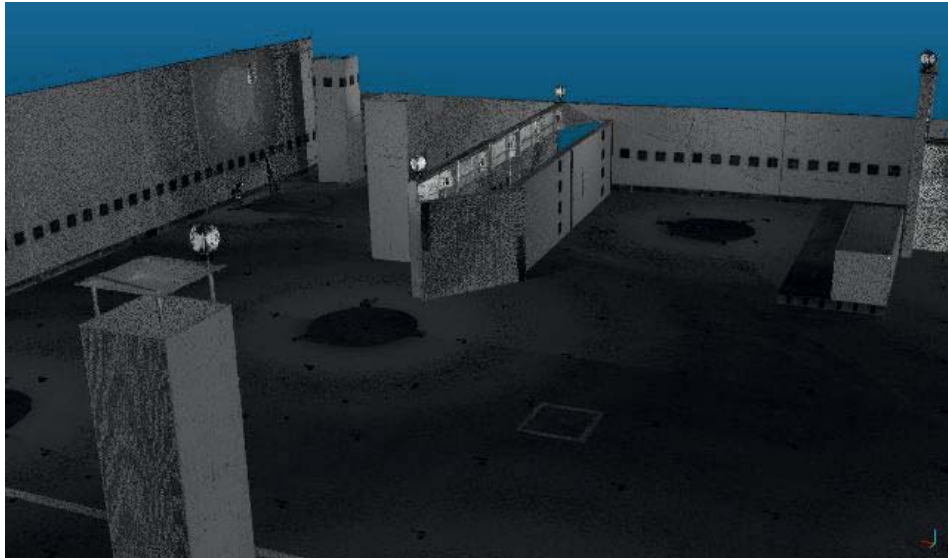
Abbildung 7.3: 3D-Punktwolke der Modellumgebung aus der Vermessung durch einen 3D-Laserscanner
