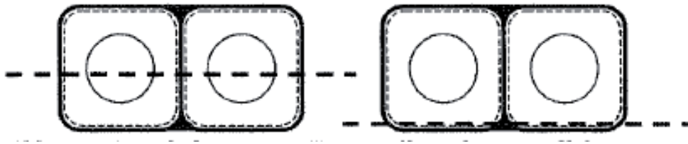
Abbildung 87: Bruchebenen von Transwall- (links) und Intrawall fracture (rechts) nach LUKOWSKI 1999
