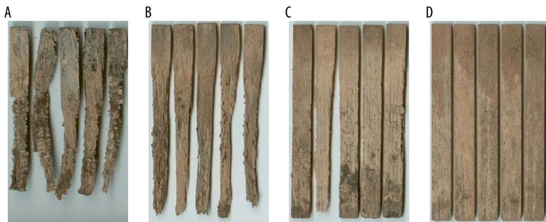
Abbildung 41: Kontrollen (A), Prüfkörper behandelt mit DMDHEU 0,8M (B), Prüfkörper behandelt mit DMDHEU 1,3M (C) sowie Prüfkörper behandelt mit DMDHEU 2,3M nach 152 Wochen Versuchsdauer in Anlehnung an ENV 807
