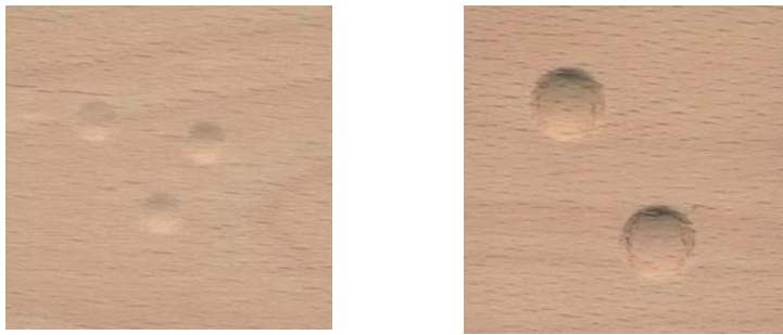
Abbildung 48: Härteprüfung nach BRINELL (links) und JANKA (rechts)
