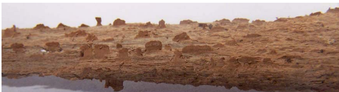
Abbildung 42: Abbaumuster eines Prüfkörpers behandelt mit DMDHEU 0,8M nach 152 Wochen Versuchsdauer in Anlehnung an ENV 807
