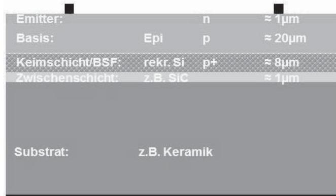
Abb. 2.3: KSD Konzept auf einem Fremdsubstrat (RexWE).
