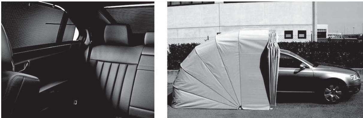
*Bild 46: Sonnenschutzrollo und faltgarage zur Reduktion von Wärmeverlusten bei abgestelltem Fahrzeug (Bildquelle: Mercedes-Benz und <http://www.zeltgarage.eu>)*
