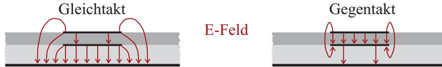
Abbildung 2.9.: Schematische Darstellung der Feldwellentypen für den Gleichtakt- und Gegentaktbetrieb eines Inline-Übergangs zwischen zwei Parallelplattenleitungen.
