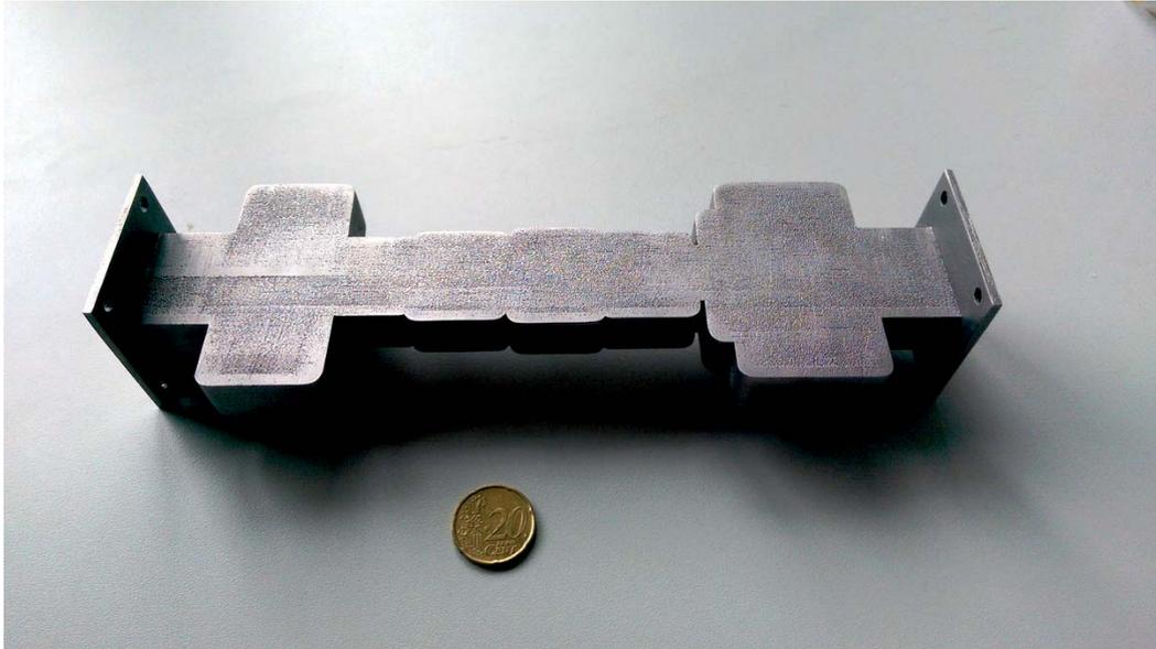
Abbildung 5.2.: Foto des mit Lasersintertechnik hergestellten Bandpassfilters aus Aluminium. Die Flanschflächen wurden mechanisch nachbearbeitet.
