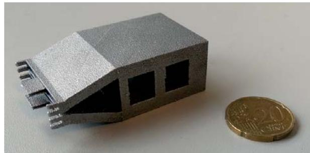
Abbildung 5.12.: Fotografie des aus Aluminium hergestellten Hybrids mit integriertem Übergang von Hohlleiter auf Parallelplattenleitung.
