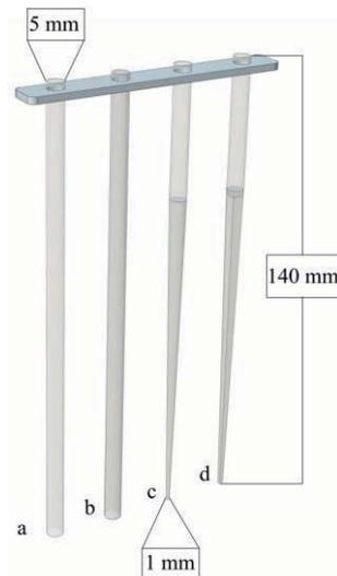
Abbildung 74: Schema der untersuchten Glasstabprototypen. Die Stäbe sind jeweils 140 mm lang und weisen an der Oberseite einen Durchmesser von 5 mm auf. (a) rund klar; (b) rund, matt; (c) rund, konisch, matt; (d) viereckig, konisch, matt.
