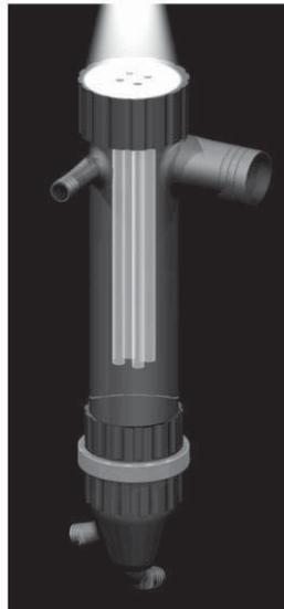
Abbildung 73: Theoretische Beleuchtung des ePBRs. Von oben werden die Borosilikatstäbe über Kaltlicht-LED's bestrahlt. Sie dienen gleichzeitig als Lichtwellenleiter und als Kultivierungsoberfläche.
