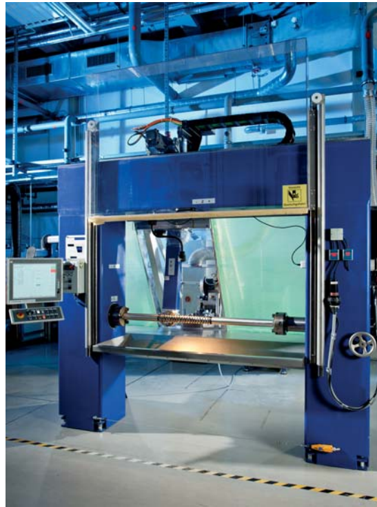
Abb. 3.15: Dornwickelmaschine vom Ingenieurbüros Hille des Fraunhofer Zentrums für Hochtemperatur-Leichtbau
