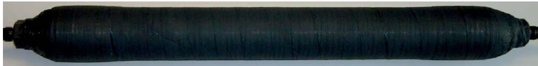
(b) In N 2 pyrolysiertes Metall-Keramik-Hybridrohr (Rohr 2, 700 °C, 1 h)
