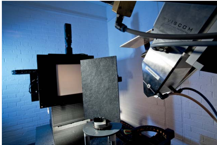
Abb. 3.29: Mikrofokus-Computer-Tomograph am Fraunhofer Zentrum für Hochtemperatur-Leichtbau
