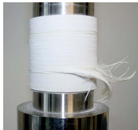
(b) 89°: Riss eines Faserbündels
