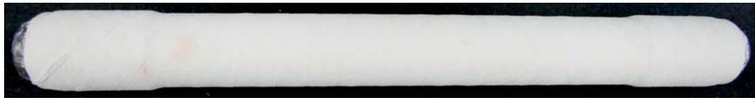
(a) In Luft pyrolysiertes Metall-Keramik-Hybridrohr (Rohr 1, 700 °C, 1 h)
