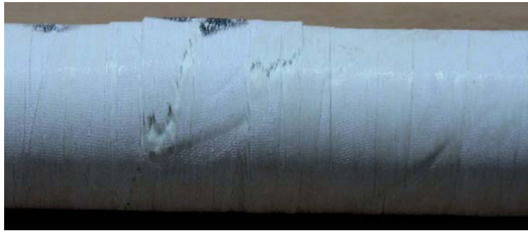
Abb. 4.39: Defektes Metall-Keramik-Hybridrohr 1 nach 3655 Stunden (35 MPa, 600 °C, Luft)
