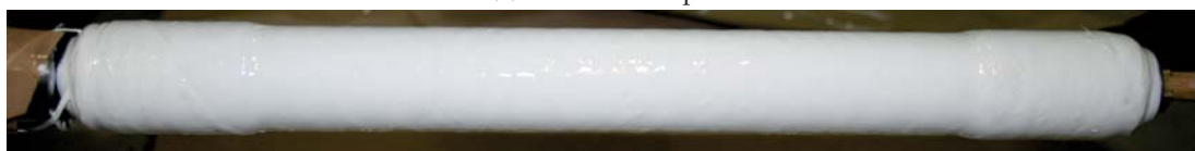
(b) Bewickelter Stahl-Prüfkörper mit noch nicht vernetzter Matrix
