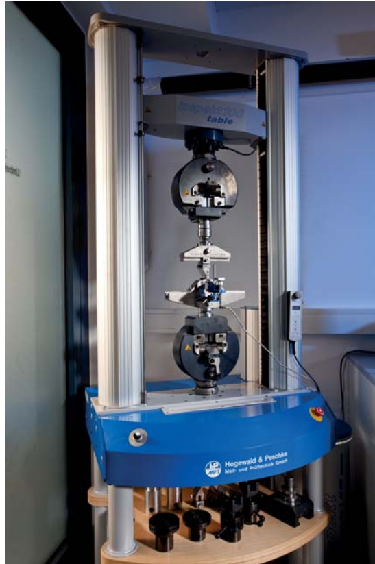
Abb. 3.26: Statische Universalprüfmaschine Inspekt table der Firma Hegewald und Peschke Mess- und Prüftechnik GmbH
