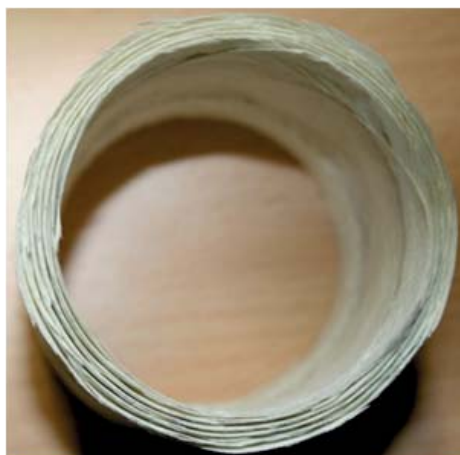
(a) 55°: Delamination der Faserlagen
