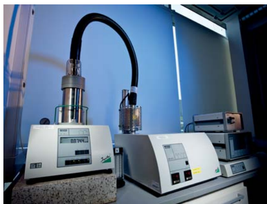
Abb. 3.19: Thermogravimeter STA 449 Jupiter C mit gekoppeltem Massenspektrometer QMS 403 C Aëolos (NETZSCH-Gerätebau GmbH)
