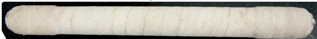
(c) Hybridrohr mit vernetzter Matrix (220 °C, 12 h, Luft)
