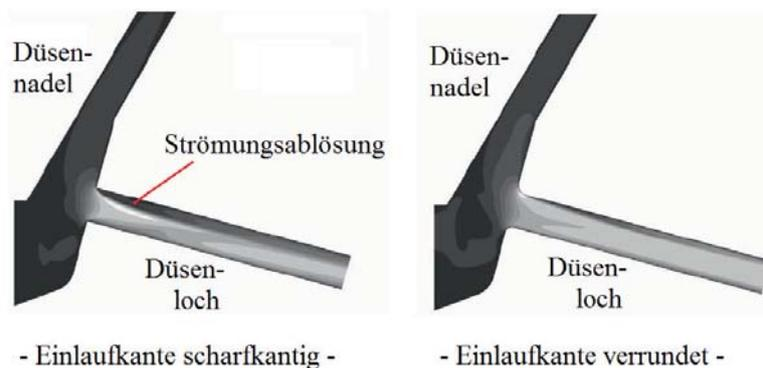
Abbildung 2.8: Kavitationserscheinung in der Einspritzdüse, nach [Mol07]
