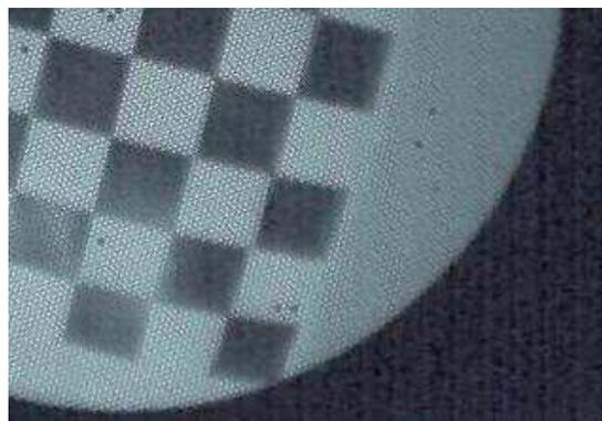
Abbildung 2.3: Wabenstruktur eines durch Glasfasern übertragenen Bildes
