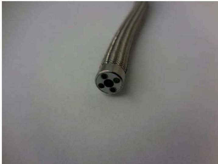
Abbildung 3.1: Integrierte Lichtleiter zur Objektbeleuchtung
