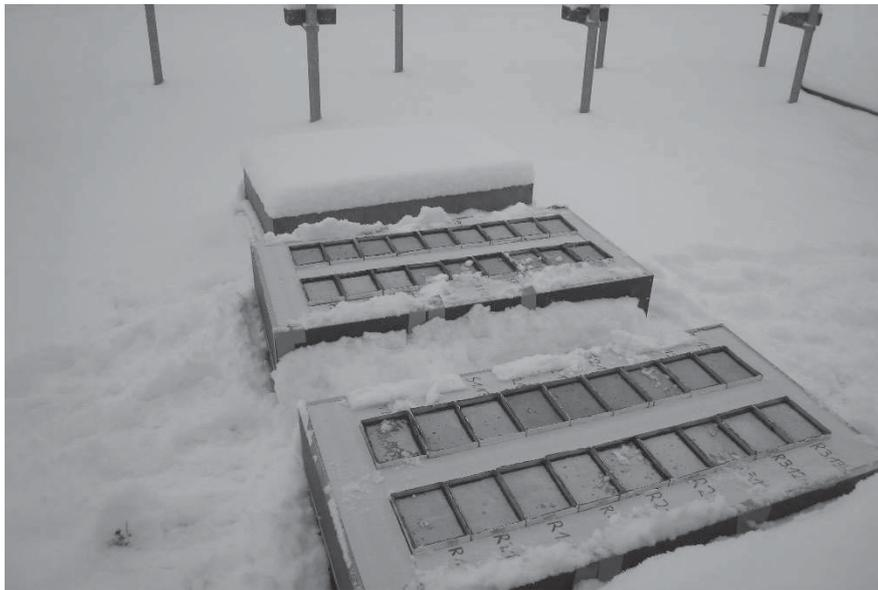
**Abbildung 17: Freilagerung der Probekörper in Kisten in Holzkirchen.
