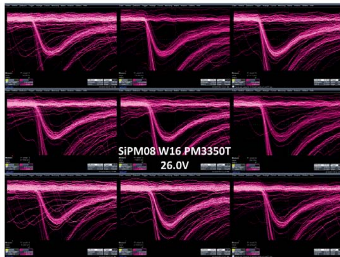
Abbildung 4.3: Signalformen von Einzelphotonen-Pulsen bei lokaler Beleuchtung eines SiPM mit optischen Barrieren zwischen den Mikrozellen.
