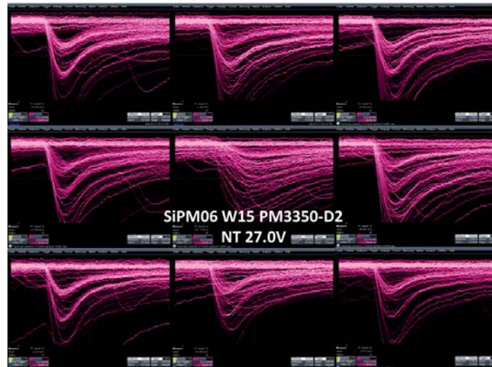
Abbildung 4.2: Signalformen von Einzelphotonen-Pulsen bei lokaler Beleuchtung eines PM3350N ohne optischen Barrieren zwischen den Mikrozellen. Die Pulsformen aus der Mitte des SiPM erfahren aufgrund des deutlich längeren Signalpfades im vergrabenen Kathodengebiet eine deutliche Dämpfung.
