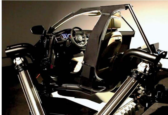
Abbildung 2-12: Fahrsimulator mit Hexapod als typisches Beispiel einer Bewegungsplattform mit sechs Freiheitsgraden (Quelle: AUDI AG)
