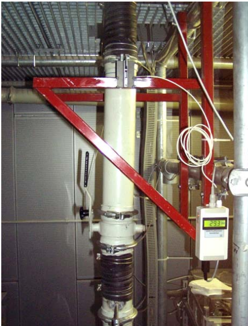
Abb. 5.10: Klappensystem zur Bestimmung des durchschnittlichen Feststoffmassenstroms G_s
