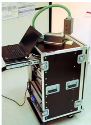
(a) Realisiertes transportables Messsystem mit integriertem Faserstreckter zur Reflexionsmessung.
