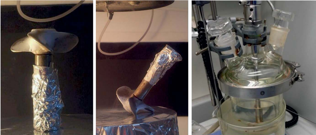
Abbildung 5.56: Fotos der Herstellung und Einsatz eines biokatalytischen Rührers. (189)
