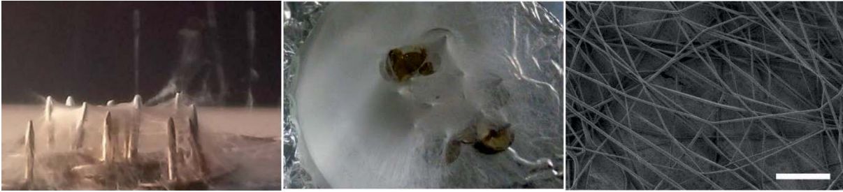
Abbildung 5.41: Elektrospinprozess von PEOx-Mischungen ( DP_{\text{set}} = 5000 und DP_{\text{set}} = 20 , jew. 15 Gew% in der Spinnlösung) Links: Foto der Faserherstellung. Mitte: Foto der gesponnenen Nanofasern. Rechts: REM-Aufnahme der elektrogewonnenen Fasern. Spannung 24 kV, Flussrate 0,001 \frac{\text{mL}}{\text{min}} ; Länge des Balkens 5 \mu\text{m} .
