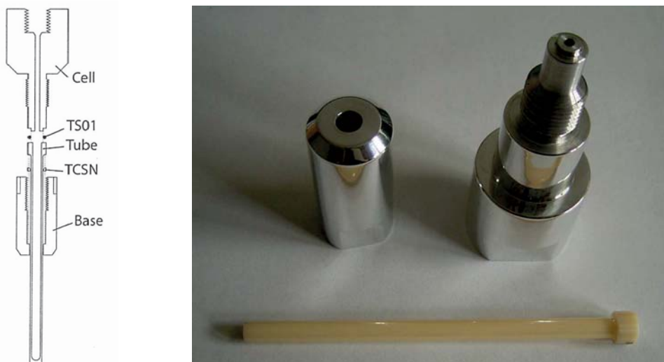
Abbildung 4.1: Aufbau der Hochdruckzelle aus Zirkonoxidkeramik
