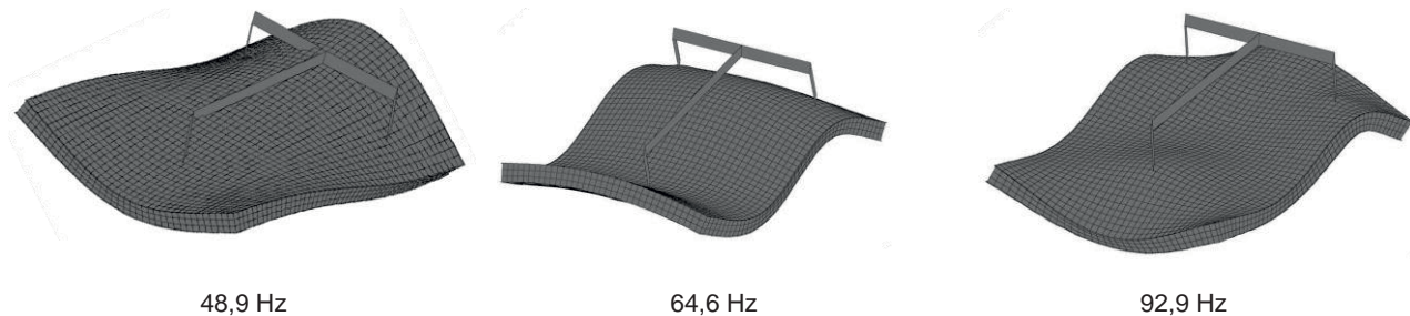
Abb. 5.21 Darstellung Eigenmoden der Spannplatte Fahrwerk-Antriebsstrang-Prüfstand aus [149]
