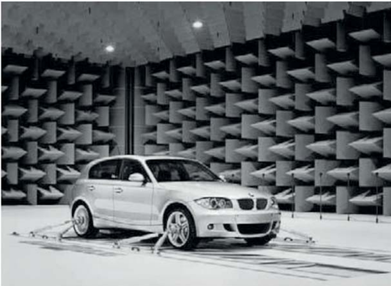
Abb. 2.21 Fahrzeugrollenprüfstand mit Semifreifeldraum ([93], [26])
