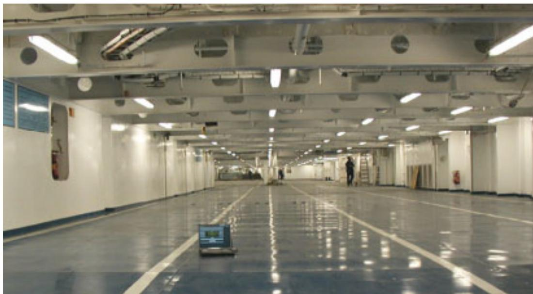
Abbildung 6.2: Ausbreitungsmessung innerhalb des Frachtdecks eines Fährschiffs. Selbst mit Modulen mittlerer Leistung und ohne direkten Sichtkontakt zwischen Sender und Empfänger konnte der gesamte Frachtbereich zuverlässig abgedeckt werden.
