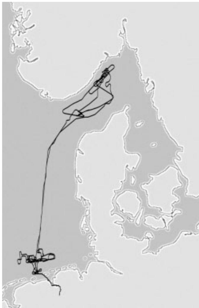
Abbildung 6.8: Route eines Kreuzfahrtschiffs während der Werftprobe- und Überführungsfahrten in der Nordsee. Die Daten wurden über die installierte, funkgestützte GPS- und Wetterstation aufgezeichnet. Die Route entspricht den Routen der Schiffe der Meyer Werft während der Werfterprobung.
