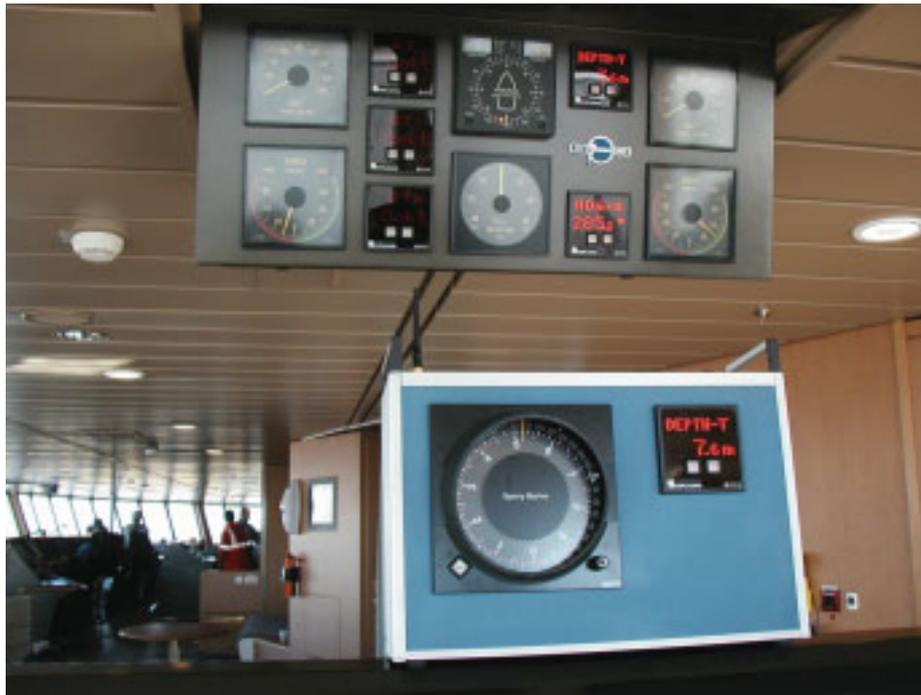
Abbildung 8.2: Drahtlose Tochteranzeige (unten), basierend auf kommerziellen Anzeigeelementen, wie sie auch in klassischen Tochteranzeigen (oben) verwendet werden. Die Antenne der batteriebetriebenen, tragbaren Anzeige befindet sich links oben am Gehäuse. Die linke Anzeige zeigt den Kurs des Schiffs an, die rechte kann beliebige NMEA-Daten darstellen (hier die Wassertiefe). Ein Ausfall bzw. eine Unterbrechung der Funkverbindung wird über die Anzeigeelemente sowie akustisch signalisiert.
