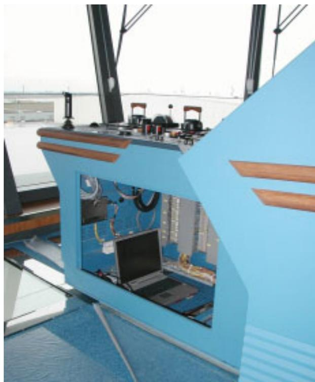
Abbildung 6.4: In die Backbord-Brückenock eines Kreuzfahrtschiffs installierter, drahtlos über Bluetooth an einen Schiffsrechner angebundener Laptop
