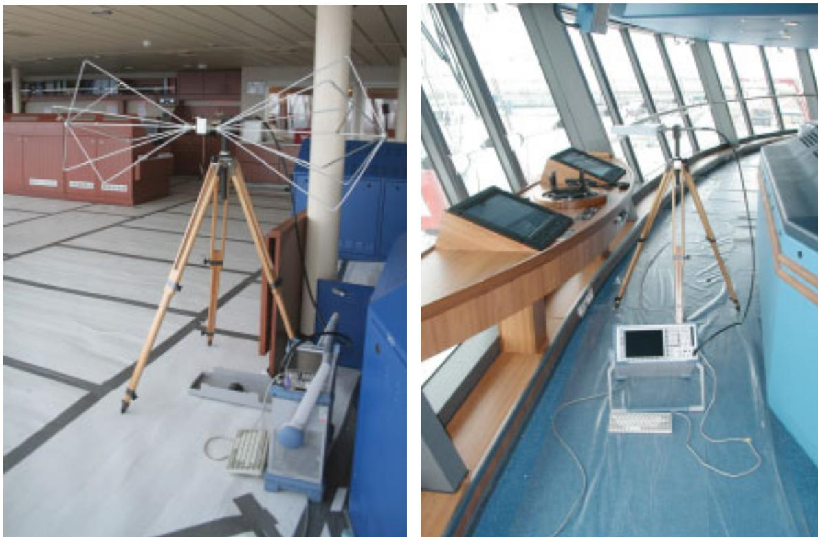
Abbildung 5.3: Mobile Messaufbauten zur Untersuchung der elektromagnetischen Strahlung auf Schiffen. Links: bikonische Antenne für niedrige Frequenzen zwischen 30 MHz und 300 MHz, rechts: logarithmisch-periodische Antenne für hohe Frequenzen zwischen 700 MHz und 18 GHz
