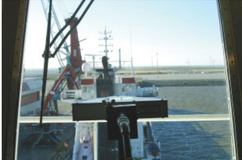
Abbildung 5.14: Messung der Feldstärken an der Radaranlage eines dicht ankernden Schiffs. Durch die unterschiedlichen Brückenhöhen liegt die Radaranlage des fremden Schiffs auf der Höhe der eigenen Brücke, wodurch diese sich in der Hauptkeule der Radarantenne befindet.
