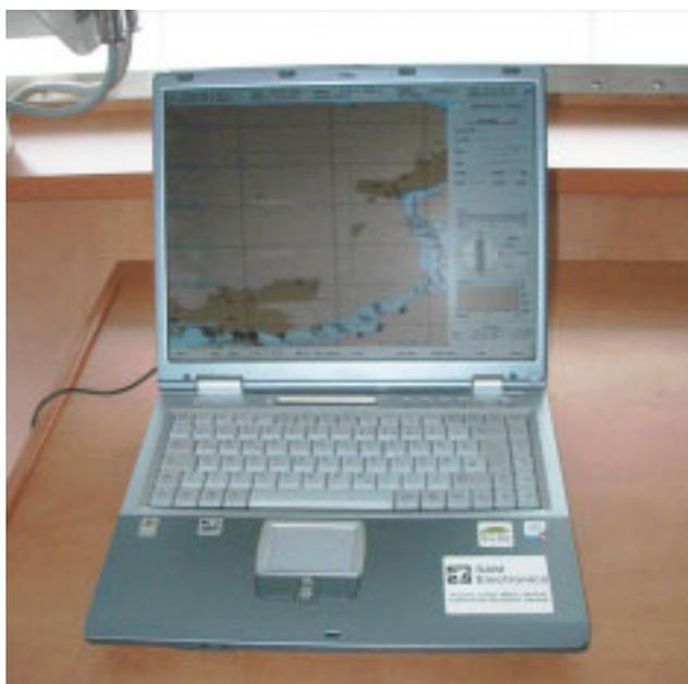
Abbildung 6.1: Laptop-PC als universelle Multifunktionsanzeige. Der Anwender kann hier zwischen verschie- denen Darstellungsmasken und darzustellenden Größen wählen. Auch ließen sich weitere Pro- gramme oder Dienste, wie z.B. VoIP<sup>2</sup> oder CCTV<sup>3</sup> implementieren. Foto: SAM Electronics [SAM]
