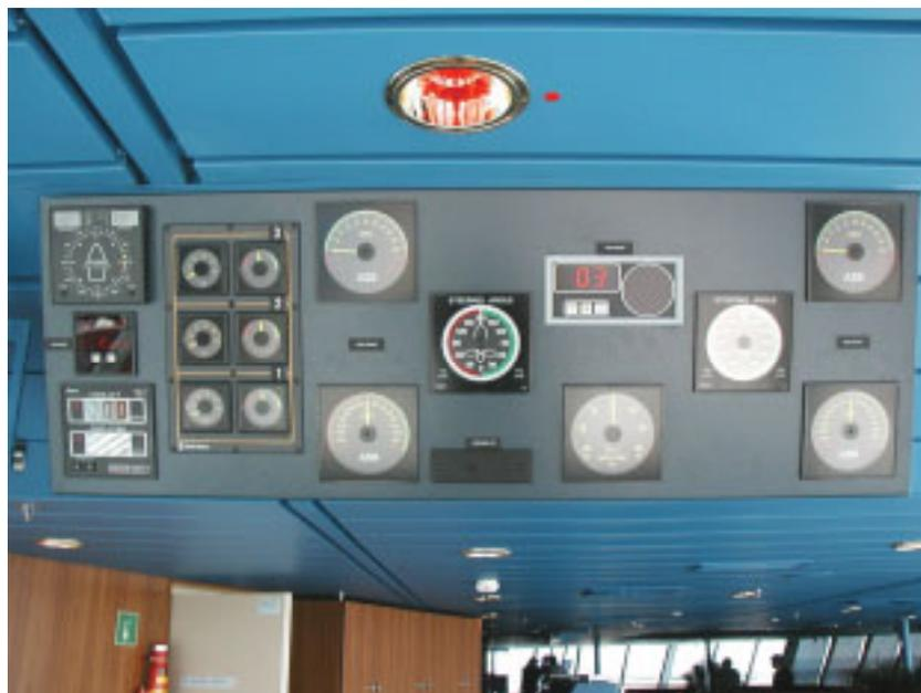
Abbildung 2.2: Tochteranzeige über dem Seitenfahrstand eines Kreuzfahrtschiffs. In den Anzeigen werden die wichtigsten Größen wie Schiffskurs, Maschinenleistung und Ruderstellung schnell erkennbar dargestellt. Viele der Anzeigeelemente sind dabei ebenfalls im zur Tochteranzeige zugehörigen Seitenfahrstand vorhanden.
