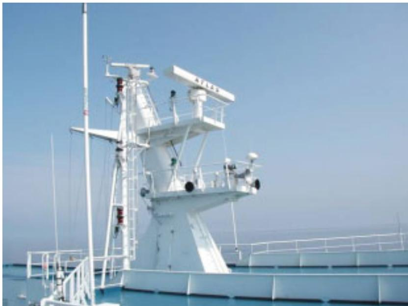
Abbildung 5.13: Peildeck einer Fähre. Erkennbar sind ein S-Band- (große Antenne) sowie ein X-Band-Radarsystem (kleine Antenne). Die Radarsysteme auf dem Peildeck besitzen nahezu Rundumsicht und werden daher für vollständig umlaufende Radardarstellungen verwendet. Neben den Radarantennen sind weitere GPS- und Stabantennen sowie ein akustisches Ortungssystem erkennbar.
