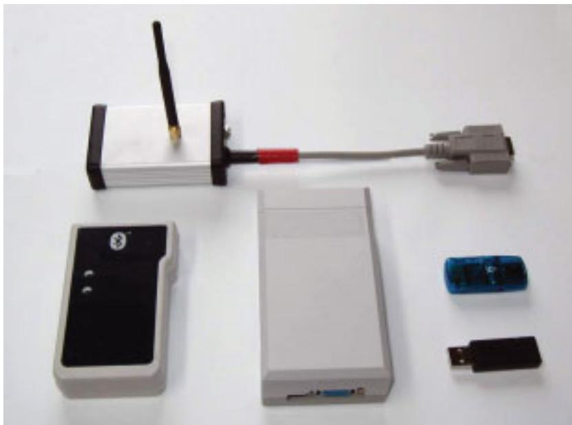
Abbildung 4.2: Bluetooth- und WLAN-Funkübertragungsmodule in unterschiedlichen Bauformen, deren abgestrahlte Felder vermessen wurden
