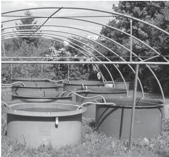
Abbildung 3-5: Mesokosmosteiche mit Verbindungsschläuchen zum Umpumpen
