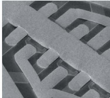
ABB. 5.64 REM-De-tailaufnahme der PSG-Verteilstruktur im 30°-Winkel, Basis-Seite.
