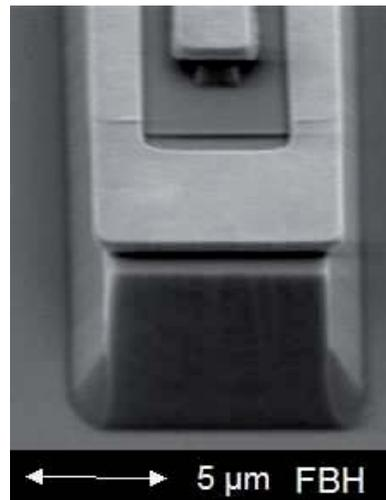
ABB. 3.2 REM-Bild einer einzelnen HBT-Zelle, im Vordergrund die Zusammenführung der beiden Basis-Kontakte.
