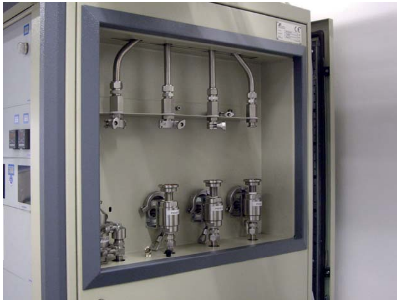
Abbildung 3.12: Vorrichtung zur Montage der Testfilter für die Partikeluntersuchung.
