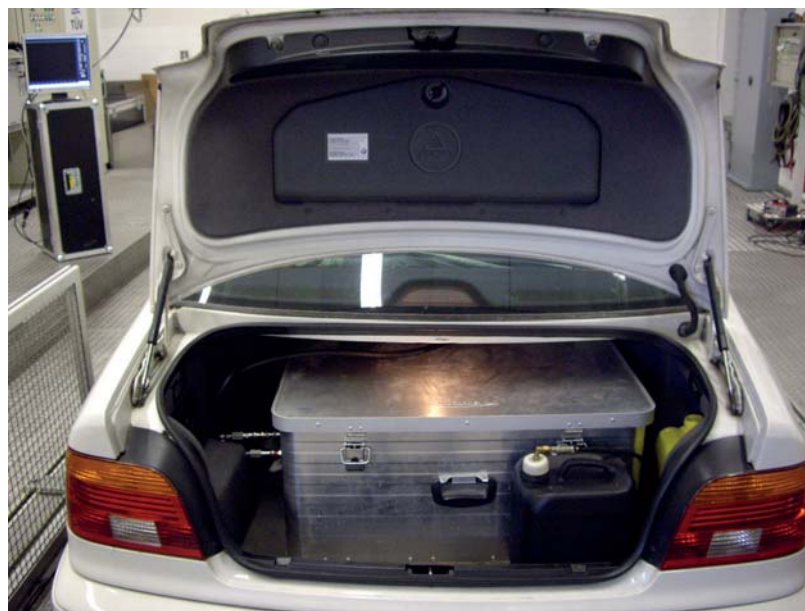
Abbildung 3.9: Kanister mit Wasser vor der Kraftstoffbox mit Kraftstoffkanistern. Links an der Box sind die Anschlüsse für die Kraftstoffleitung.
