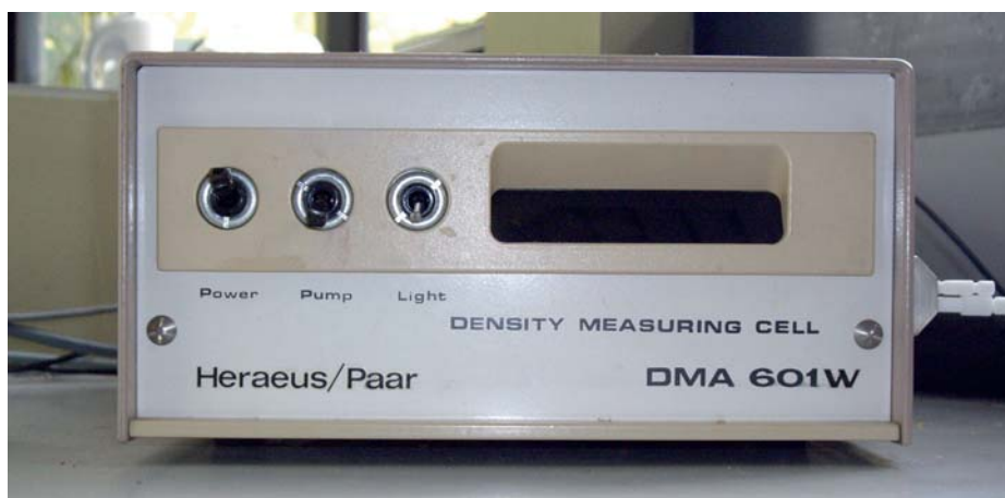
Abbildung 3.2: Verwendeter Dichteschwinger zur Bestimmung der Dichte.
