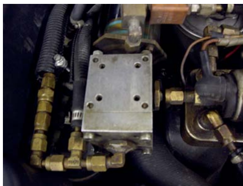
Abbildung 3.8: Links: Ventilsteuerung der Wasserbeimischung. Rechts: Emulsionspumpe des Emulsionskreislaufs Unten: Mischeinheit zur Beimischung von Wasser in den Kraftstoff.
