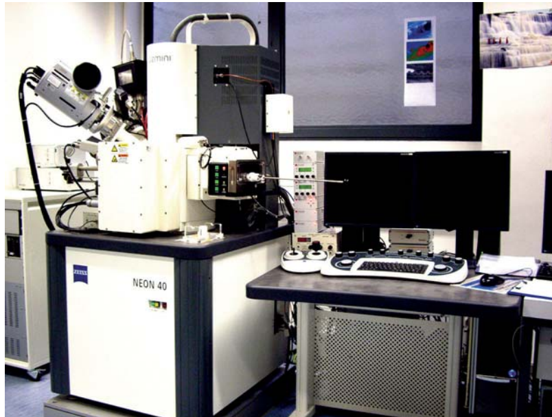
Abbildung 3.13: Verwendetes Rasterelektronenmikroskop zur Untersuchung von Rußfiltern.
