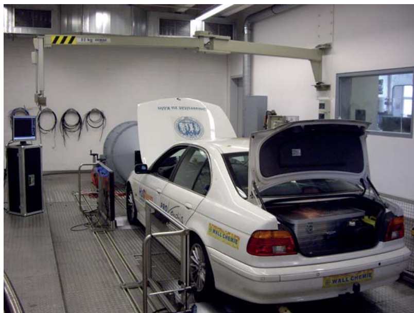
Abbildung 3.11: Testfahrzeug auf dem Rollenprüfstand mit Monitor links im Bild zur Darstellung des Fahrzyklus.
