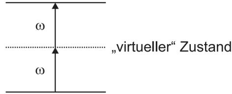
Abbildung 4.3: Schema der Zwei-Photonen-Absorption, abgewandelt aus [112]. Ein System wird vom Grundzustand in einen energetisch höheren Zustand über einen kurzlebigen, „virtuellen“ Zustand angeregt, indem gleichzeitig zwei Photonen absorbiert werden.
