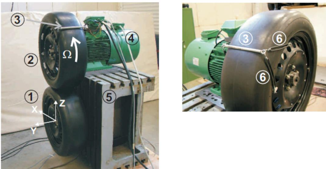
Abbildung 3.7: Prüfstandskonzept basierend auf einem Reifen-Reifen-Kontakt, [Kin09]
