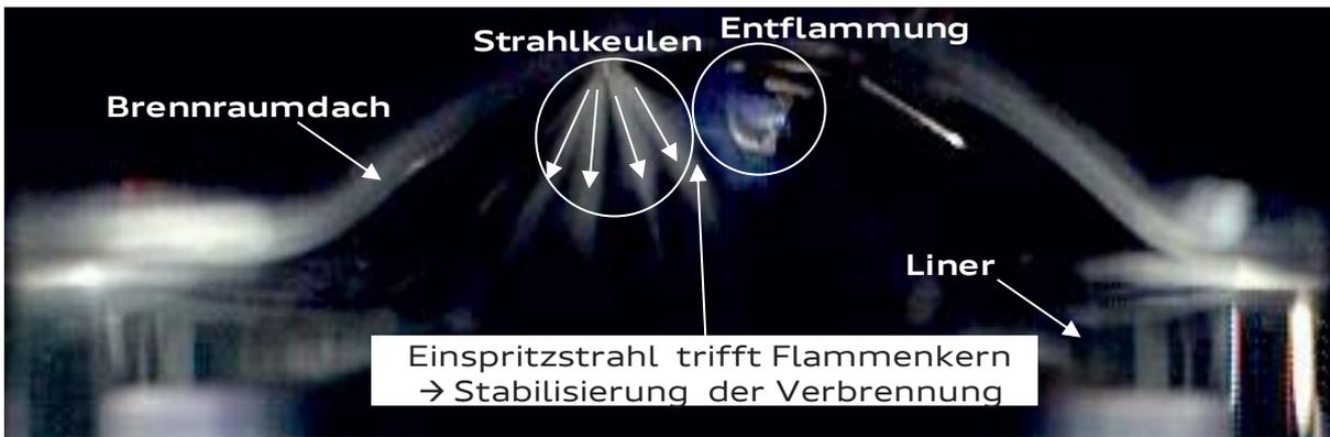
Abbildung 16: Funktionsweise Zündeinspritzung bei zentraler Injektorlage mit Mehrlochventil
