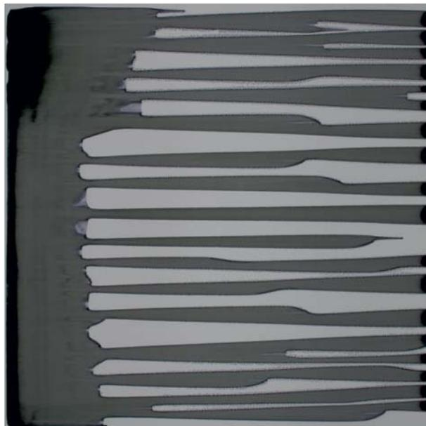
**Abbildung 5.10.:** Aufnahme eines Substrats mit Meniskusabriss
