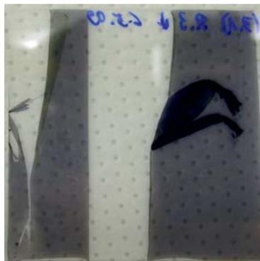
**Abbildung 5.24.:** Aufnahme eines Substrats mit streifenweiser LFK-Ablösung
