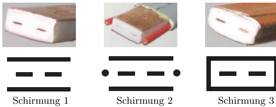
Abb. 4.8: Schirmungskonzepte: Schirmung 1 ist seitlich offen, Schirmung 2 hat zusätzliche Massedrähte und Schirmung 3 ist komplett geschlossen.
