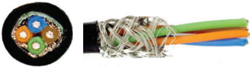
Abb. 5.2: Sternviererkabel mit Geflecht- und Folienschirmung.
