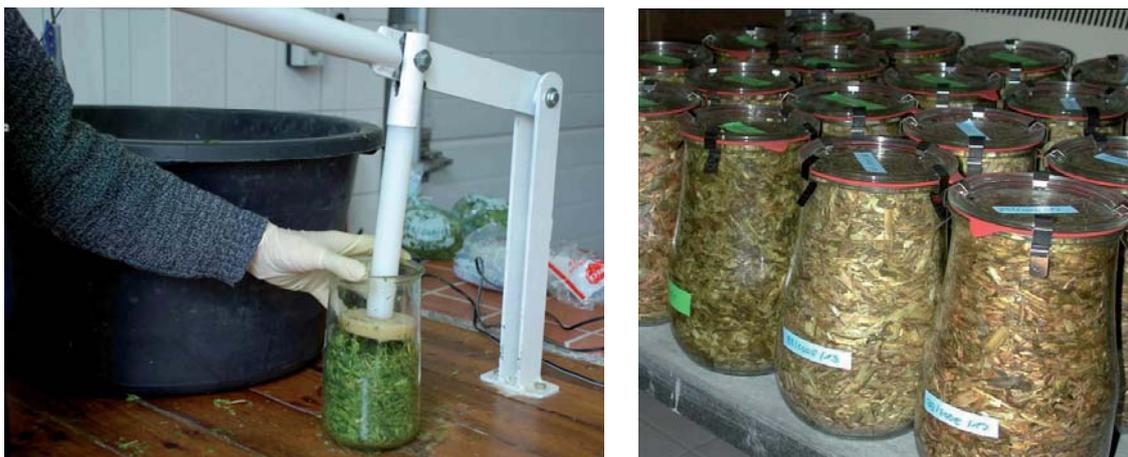
**Abb. 8: Verdichtungsapparatur zur Silierung im Labormaßstab (links) und Lagerung der Siliergläser (rechts)**
