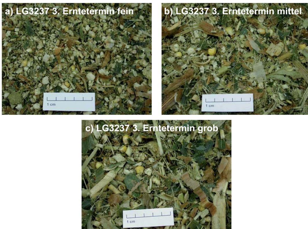
Abb. A5: Fotografische Darstellung der Maissorte LG3237 zum 3. Erntetermin bei den Hackseleinstellungen a) fein, b) mittel, c) grob (Parzellenhackslers); VS I
