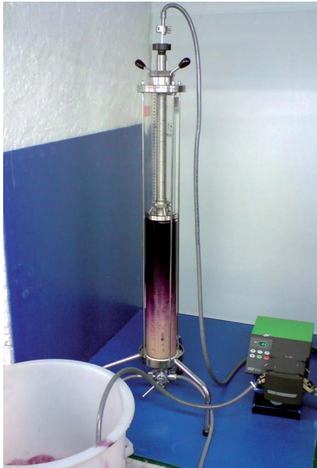
**Abbildung 132: Aufbau Adsorberharzsäule BPG 100, mit SP70 Harz**
