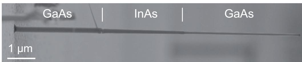
Abb.3.33: REM Aufnahme eines bei 400 °C auf (111)B GaAs Substrat gewachsenen GaAs/InAs/GaAs Nanodrahtes mit reduziertem Tapering.
