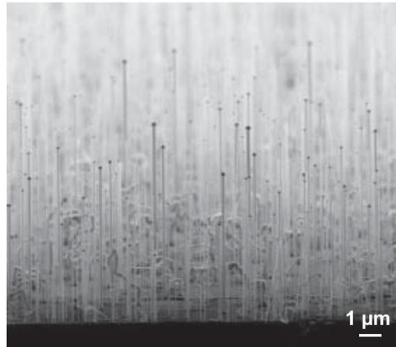
Abb. 3.44: REM-Aufnahme von bei 400 °C gewachsen GaAs Nanodrähten mittels einer zuvor aufgedampften, 2,5 nm dicken Au-Schicht, und einem II/III-Verhältnis von 0,008. Zu Beginn wurden die Drähte auch hier bei 450 °C ohne DEZn Angebot angewachsen.
