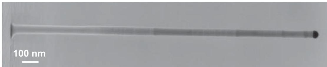
*Abb.3.27: REM Aufnahme eines GaAs/GaP/GaAs Nanodrahtes mit optimierten Wachstumsbedingungen. Additives Schichtwachstum konnte nahezu vollständig unterdrückt werden.*
