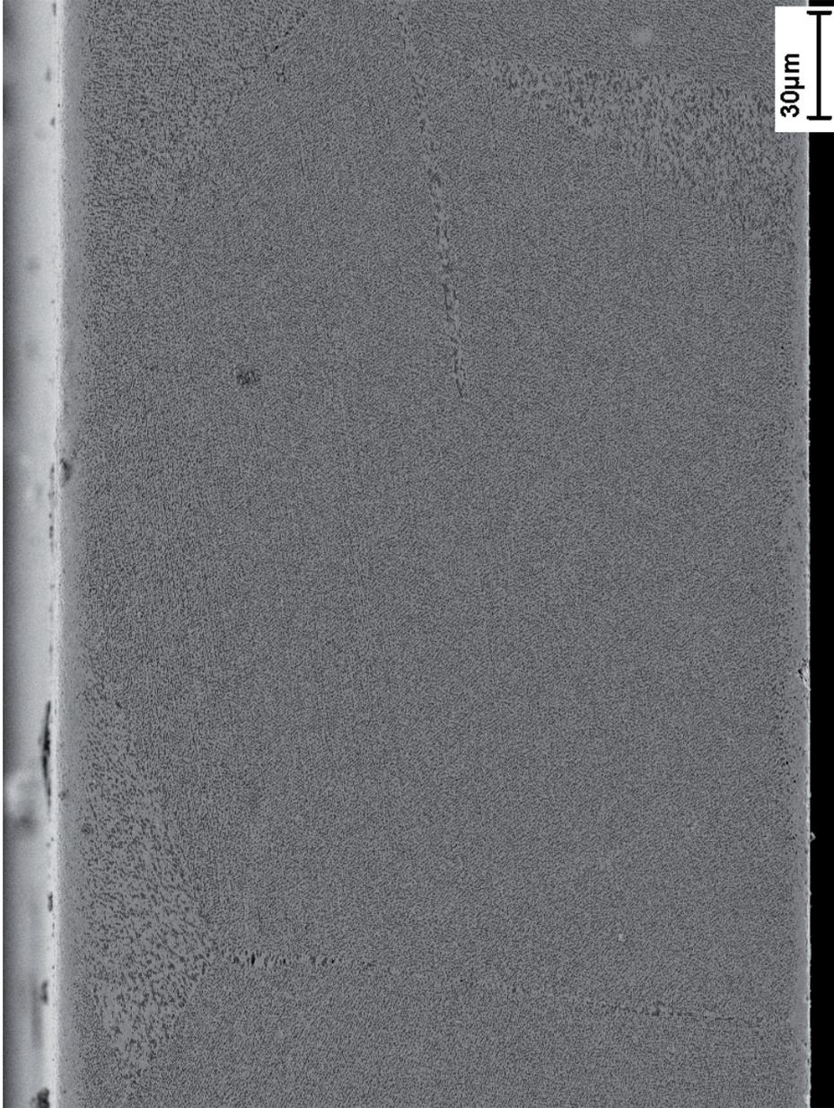
Abbildung 6.4: Querschnitt einer vollständig porösen ca. 225  $\mu\text{m}$  dicken Membran aus Legierung 115 NC nach 4 h in  $\text{MoO}_3$ -Säure. Die gerichtete Vergrößerung wurde im Walzprozess eingestellt. Aufgrund der Fixierung der Probe im Präparationsprozess wurden die Oberflächen verformt, daher sehen Ober- und Unterseite der Membran solide aus.
